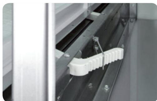
Специальный прижимной механизм для фильтров
